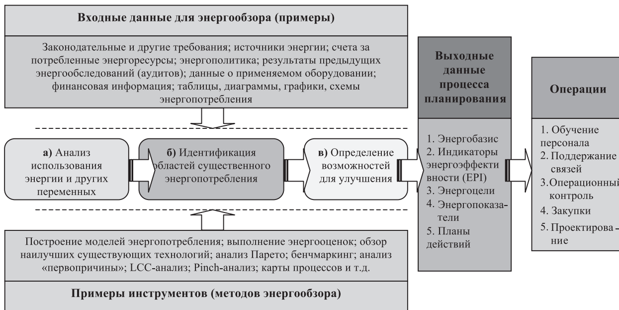
Рис. 1. Принципиальная схема процесса энергопланирования
