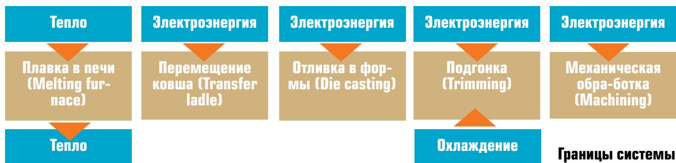
Рис. 2. Пример блок-схемы процесса для операции по отливке металла в формы (включая «входы и «выходы» энергии)
